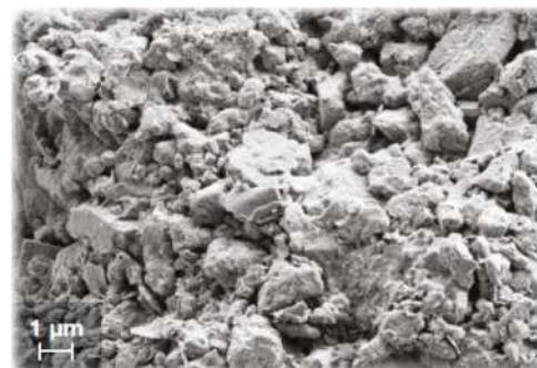
Částice suroviny pro výrobu AtriGranu zvětšená 5000x
